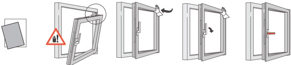
Ihre PVC-Fenster sind mit einer Fehlbedienungssperre ausgestattet. Sollte dennoch mal eine Fehlschaltung erfolgen, muss diese erst manuell betätigt werden.
